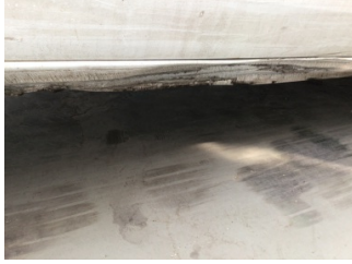
Marşbiyel, sağ, Marşbiyel, sağ > Hasarlı
