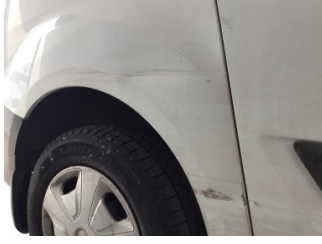
Çamurluk, sağ arka, Çamurluk, sağ arka > Ezik
