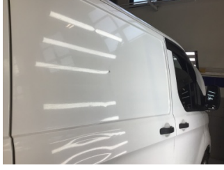
Kapı, sağ arka, Kapı, sağ arka > Ezik
