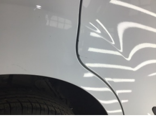
Kapı, sağ arka, Kapı, sağ arka > Çizik
