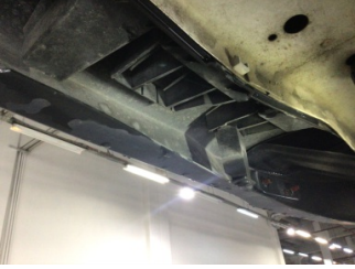
Tampon, arka, Bağlantı ayağı > Hasarlı
