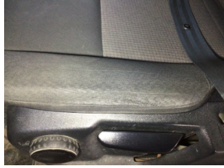
Koltuklar, ön, Koltuk, sol ön > Deforme Olmuş
