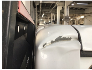
Kaporta, C-direk, sağ > Hasarlı
