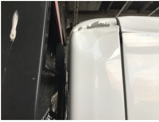
Kaporta, C-direk, sağ > Hasarlı
