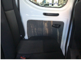
Döşemeler/Kapaklar, Kapı döşemesi, sol arka > Deforme Olmuş
