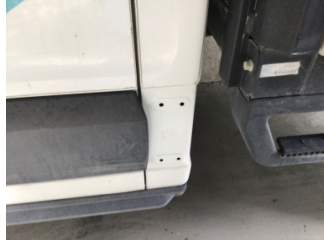
Döşemeler/Kapaklar, Döşemeler/Kapaklar > Eksik
