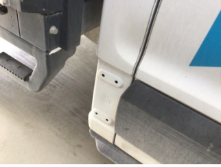
Döşemeler/Kapaklar, Döşemeler/Kapaklar > Eksik
