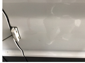
Kapı, sol arka, Kapı, sol arka > Noktasal Ezik
