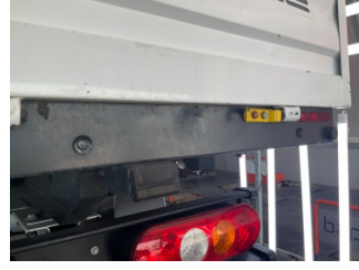
Bagaj kapağı/kapısı, Bagaj kapısı > Ezik
