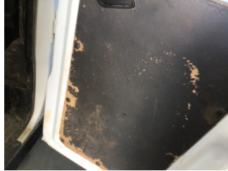
Döşemeler/Kapaklar, Kapı döşemesi, sağ arka > Hasarlı
