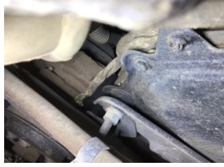
Motor, Triger zinciri kapağı > Yağ Kaçağı
