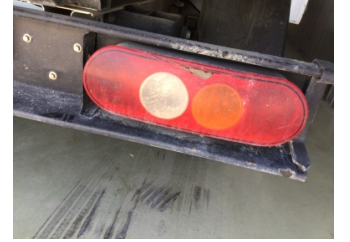
Arka lambalar, Arka lambalar, sağ > Hasarlı
