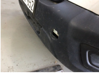
Tampon, ön, Çeki demir kapağı > Sökülmüş-Yok
