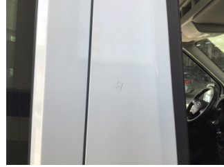
Kapı, sağ ön, Kapı, sağ ön > Çizik
