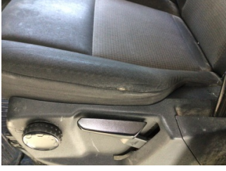
Koltuklar, ön, Koltuk döşemesi, sol ön > Deforme Olmuş
