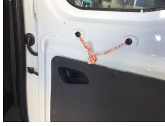
Kapı, sağ arka, Kapı kolu, iç > Sökülmüş-Yok
