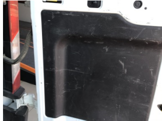
Döşemeler/Kapaklar, Döşemeler/Kapaklar > Çizik
