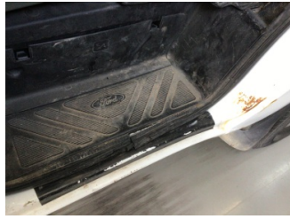
Kapı, sağ ön, Kapı fitili > Deforme Olmuş
