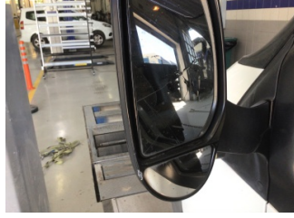
Dikiz aynası, sol, Dış dikiz aynası > Hasarlı
