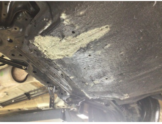
Motor, Alt muhafaza > Hasarlı
