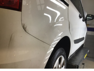
Çamurluk, sağ arka, Çamurluk, sağ arka > Ezik
