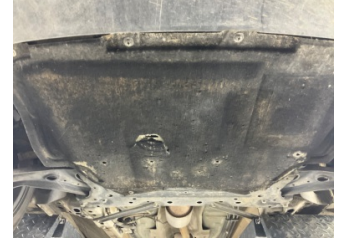
Motor, Alt muhafaza > Hasarlı
