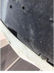
Tampon, ön, Tampon koruyucu sol > Hasarlı
