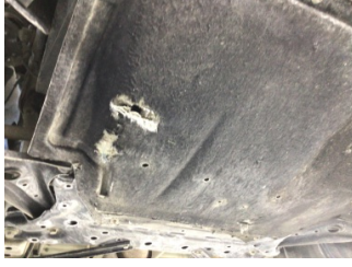
Motor, Alt muhafaza > Hasarlı
