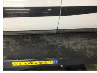
Marşbiyel, sol, Kriko noktası kapağı, sol > Hasarlı
