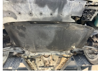
Motor, Alt muhafaza > Hasarlı
