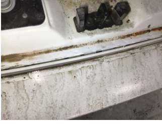
Arka bölüm, Arka sac/panel > Standart Dışı Onarım
