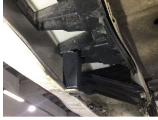
Tampon, arka, Bağlantı ayağı > Hasarlı
