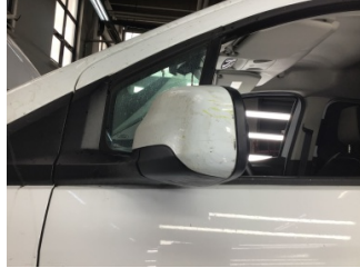
Dikiz aynası, sol, Dış dikiz aynası > Çizik
