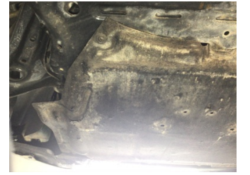
Motor, Alt muhafaza > Hasarlı
