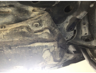
Motor, Alt muhafaza > Hasarlı
