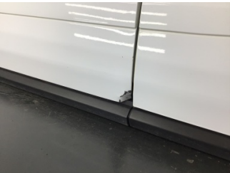
Kapı, sol ön, Kapı, sol ön > Hasarlı
