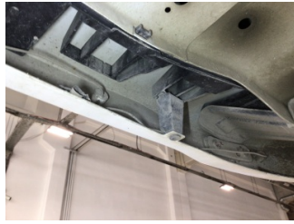
Tampon, arka, Bağlantı ayağı > Hasarlı
