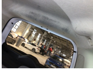
Döşemeler/Kapaklar, Tavan döşemesi > Deforme Olmuş
