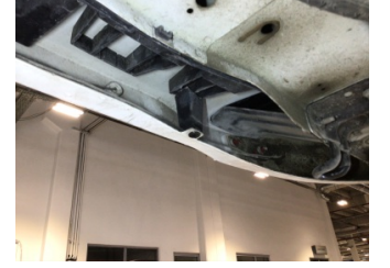
Tampon, arka, Bağlantı ayağı > Hasarlı
