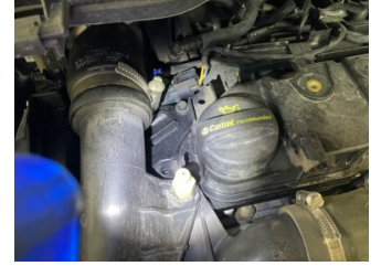
Motor, Motor üst kapağı, plastik > Yağ Kaçağı
