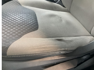
Koltuklar, ön, Koltuk döşemesi, sol ön > Hasarlı
