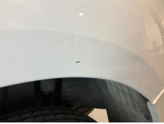
Çamurluk, sol arka, Çamurluk, sol arka > Çizik
