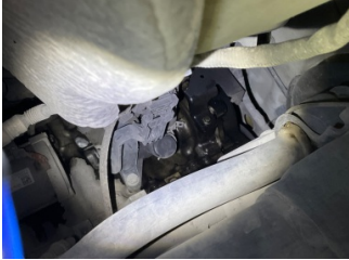
Motor, Motor üst kapağı, plastik > Yağ Kaçağı
