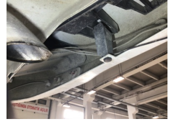
Tampon, arka, Bağlantı ayağı > Hasarlı
