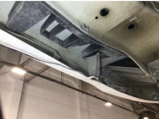
Tampon, arka, Bağlantı ayağı > Hasarlı
