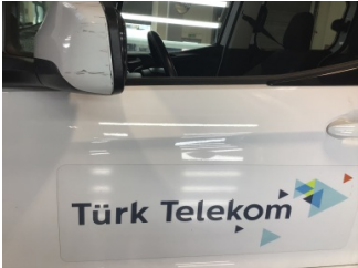
Dikiz aynası, sol, Dış dikiz aynası > Çizik
