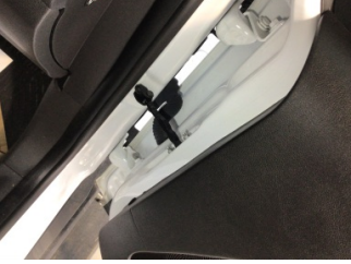
Kapı, sağ ön, Kapı gergisi > Ses Yapıyor
