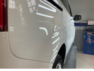
Çamurluk, sağ arka, Çamurluk, sağ arka > Ezik
