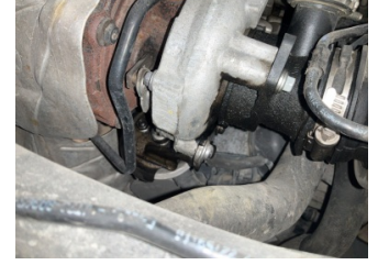
Motor, Turbo hortumları > Yağ Kaçağı
