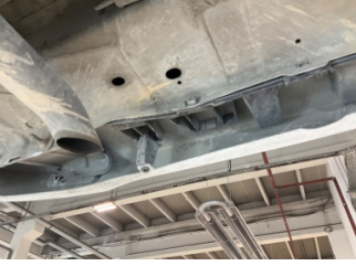
Tampon, arka, Bağlantı ayağı > Hasarlı
