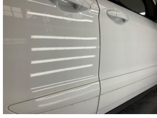
Kapı, sağ arka, Kapı, sağ arka > Ezik
