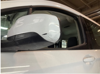
Dikiz aynası, sol, Dış dikiz aynası > Çizik
