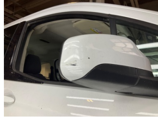
Dikiz aynası, sağ, Dış dikiz aynası > Çizik
