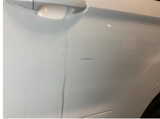
Kapı, sol arka, Kapı, sol arka > Çizik
