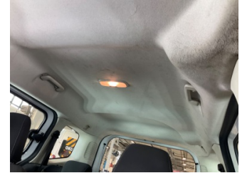
Döşemeler/Kapaklar, Döşemeler/Kapaklar > Deforme Olmuş
