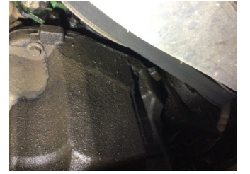
Motor, Triger zinciri kapağı > Yağ Kaçağı
