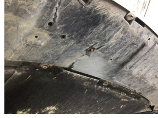
Motor, Alt muhafaza > Hasarlı
