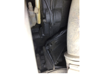
Motor, Motor üst kapağı, plastik > Yağ Kaçağı
