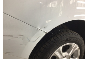
Çamurluk, sol arka, Çamurluk, sol arka > Hasarlı
