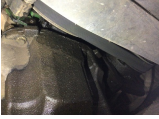
Motor, Triger zinciri kapağı > Yağ Kaçağı
