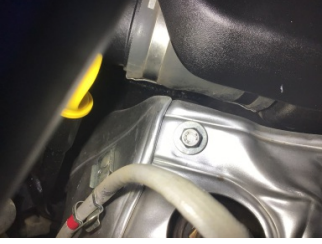
Motor, Motor üst kapağı, plastik > Yağ Kaçığı
