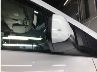
Dikiz aynası, sağ, Dış dikiz aynası > Çizik
