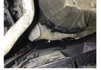
Motor, Yağ karteri > Yağ Kaçağı
