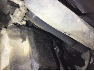
Motor, Triger zinciri > Yağ Kaçağı
