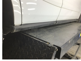
Marşbiyel, sağ, Marşbiyel plastiği, sağ > Hasarlı
