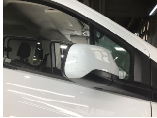
Dikiz aynası, sağ, Dış dikiz aynası > Çizik
