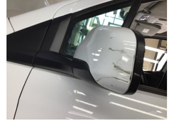
Dikiz aynası, sol, Dış dikiz aynası > Çizik
