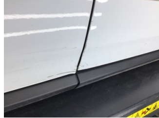
Kapı, sağ ön, Kapı, sağ ön > Çizik
