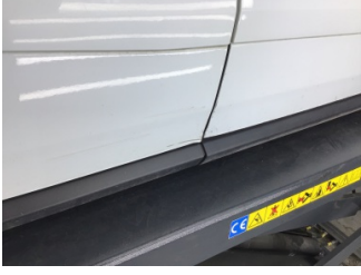
Kapı, sağ arka, Kapı, sağ arka > Ezik
