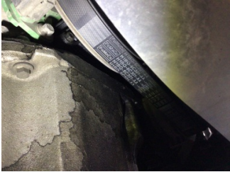
Motor, Triger kayışı > Yağ Kaçağı
