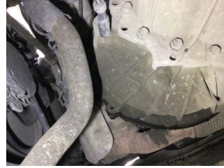
Şanzıman, Şanzıman > Yağ Kaçağı
