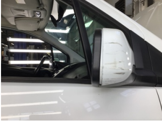
Dikiz aynası, sağ, Dış dikiz aynası > Çizik
