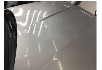
Motor kaputu, Motor kaputu > Dolu Hasarı
