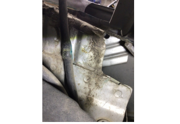
Kaporta, Sol Kılıç Sacı > Hasarlı
