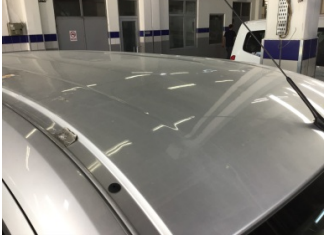
Tavan, Tavan > Dolu Hasarlı
