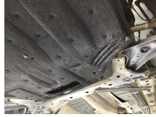
Motor, Alt muhafaza > Hasarlı
