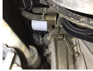
Motor, Yağ filtresi > Yağ Kaçağı
