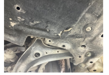
Motor, Alt muhafaza > Hasarlı
