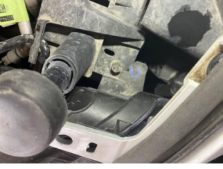
Farlar, Far bağlantı ayağı, sağ > Kırılmış
