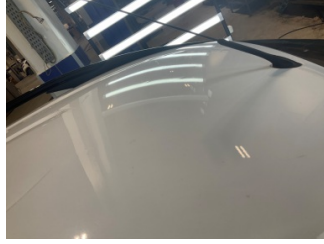
Tavan, Tavan > Dolu Hasarı
