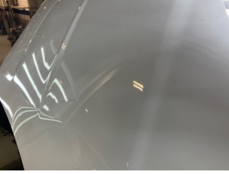
Motor kaputu, Motor kaputu > Dolu Hasarı
