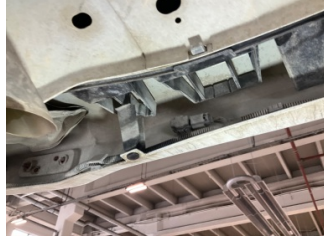
Tampon, arka, Bağlantı ayağı > Hasarlı
