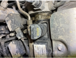
Motor, Motor üst kapağı, plastik > Yağ Kaçağı
