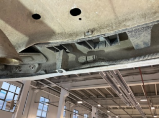
Tampon, arka, Bağlantı ayağı > Hasarlı
