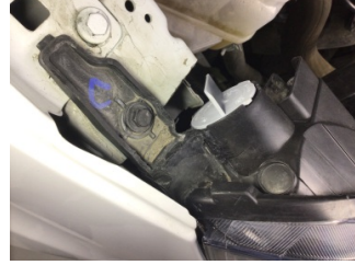
Farlar, Far, sağ > Standart Dışı Onarım
