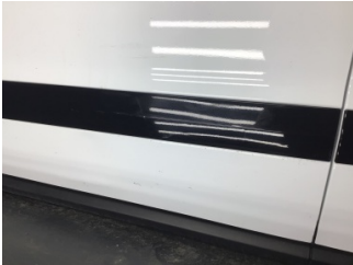
Kapı, sol ön, Kapı bandı > Çizik
