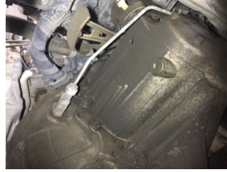
Şanzıman, Şanzıman > Yağ Kaçağı
