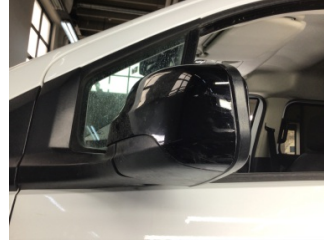
Dikiz aynası, sol, Dış dikiz aynası > Çizik
