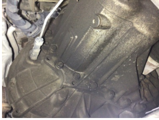
Şanzıman, Şanzıman > Yağ Kaçağı
