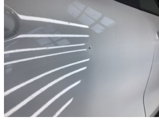
Kapı, sağ arka, Kapı, sağ arka > Noktasal Ezik
