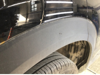
Çamurluk, sağ arka, Çamurluk ağzı > Çizik
