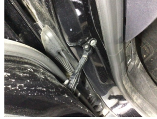
Kapı, sol ön, Kapı gergisi > Ses Yapıyor
