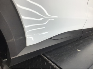
Kapı, sağ arka, Kapı, sağ arka > Ezik
