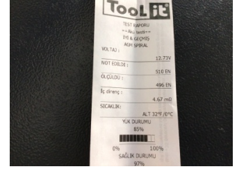
Elektrik donanımı/Pano, Akü > Test Sonucu
