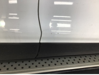
Kapı, sağ ön, Kapı, sağ ön > Çizik
