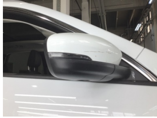
Dikiz aynası, sağ, Dış dikiz aynası > Çizik
