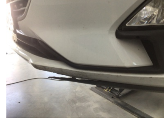
Tampon, ön, Spoyley > Hasarlı
