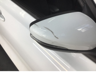
Dikiz aynası, sağ, Dış dikiz aynası > Çizik
