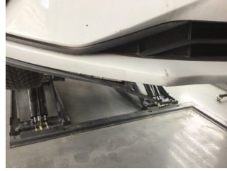
Tampon, ön, Spoyley > Hasarlı
