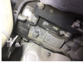
Motor, Motor üst kapağı, plastik > Yağ Kaçağı
