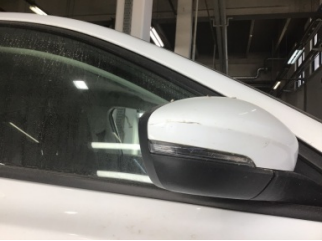
Dikiz aynası, sağ, Dış dikiz aynası > Çizik
