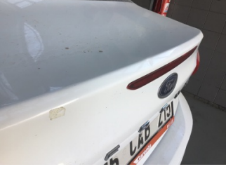
Bagaj kapağı/kapısı, Bagaj kapısı > Noktasal Ezik
