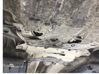
Motor, Alt muhafaza > Hasarlı
