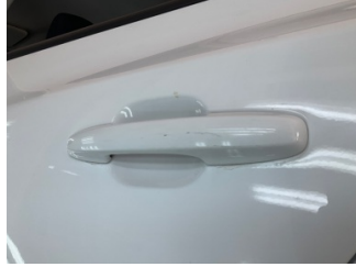
Kapı, sol arka, Kapı kolu, dış > Çizik
