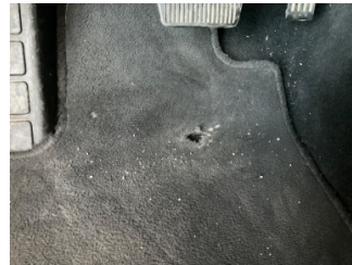
Taban, Taban halısı, sol ön > Hasarlı
