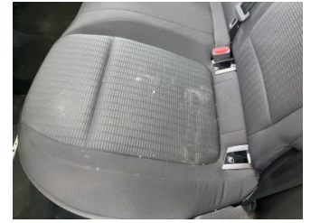
Döşemeler/Kapaklar, Döşemeler/Kapaklar > Kirlenmiş
