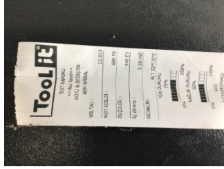
Elektrik donanımı/Pano, Akü > Test Sonucu
